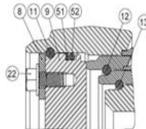
Ensemble de joints d'étanchéité No. de pièce : UI47G0423
